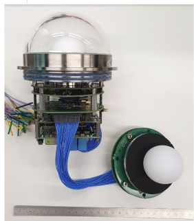
Precision Optical Calibration Module (POCAM) (21)
